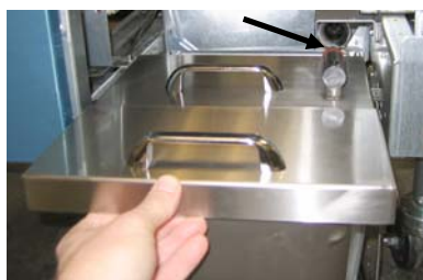
Figura 4: Ponga la tapa en la bandeja y deslice el tubo de recolección de aceite en la toma de aspiración hembra.
