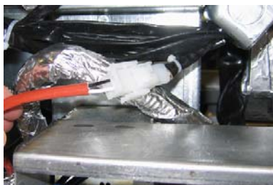
Figura 6: Conecte los conectores blancos de dos clavijas y enchufe el conector negro en la caja eléctrica como se muestra. * Tome en cuenta la posición de que el conector negro puede diferir de la foto.
