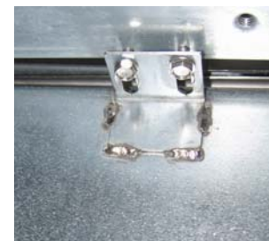
Figura 5: Fije el fundidor a los rieles en ambos lados.
